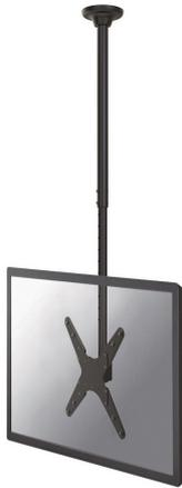
Neomounts by Newstar support de plafond pour TV/moniteur. Capacité de charge maximale: 50 kg, Taille minimale de l'écran: 81,3 cm (32"), Taille maximale de l'écran: 190,5 cm (75"), Compatibilité interface de montage (min): 100 x 100 mm, Compatibilité interface de montage (max): 400 x 400 mm. Réglage de la hauteur: 1060 - 1560 mm, Angle d'inclinaison: 0 - 25°, Angle de pivotement: 360°. Couleur du produit: Noir
